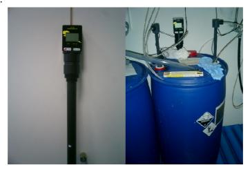
23. Juni 2020 Bericht zum ersten Testergebnis; die Füllstandsmessungen nahmen nicht ab, obwohl Produkt aus dem Gebinde entnommen wurde (Überprüfung mittels Gliedermaßstab). Mehrmalige Rekalibrierung des Gerätes blieb erfolglos. Ursache vermutlich Reflexionen des Ultraschall-Messsignals an der Messrohrwandung. Erneute Installation ohne Messrohr direkt eingesteckt in die Gebindeöffnung zeigen bessere Ergebnisse. Test wird unter den geänderten Bedingungen fortgeführt
